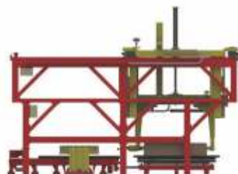
Passo 2 - Moldagem inferior é centrada no eixo "Y", posicionada sobre o palete de vazamento
