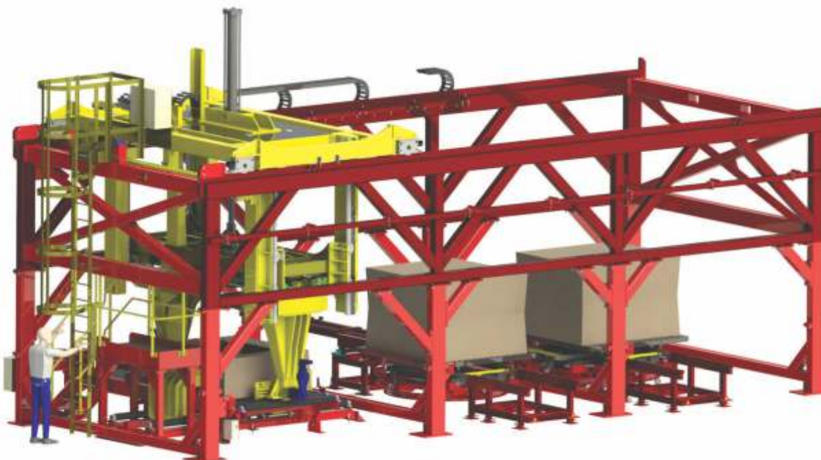
Passo 4 - Moldagem superior é centrada no eixo "Y", suspende e gira a 180°
