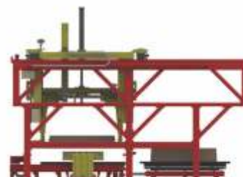
Passo 3 - Moldagem superior é centrada no eixo "X"
