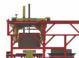
Passo 4 - Moldagem superior é centrada no eixo "Y", suspende e gira a 180°
