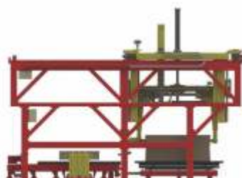
Passo 5 - Moldagem superior é fechada sobre a inferior. Alinhamento preciso assegurado por uma mesa flutuante
