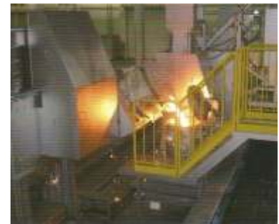
Metal Fundido transferido do carro de transferência para a panela de vazamento. (Esquerda: Carro de Transferência. Direita: Cena de um Vazamento de Panela)
